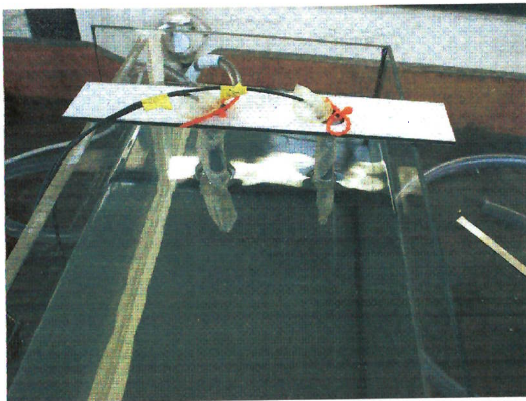
Figura 5.3.3.1: Esquema de instalação dos microfones para medição de acústica.
